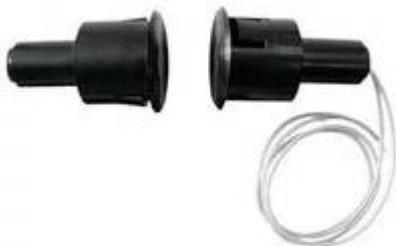
Охранный, точечный, магнитоконтактный, врезной, для скрытого монтажа в металлических (магнитопроводящих) конструкциях, конструктивно состоит из 2-х элементов: датчика магнитоуправляемого (геркона) и элемента задающего (магнита), тип применяемого геркона — нормально замкнутый(Н.З.).
