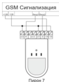
б) Подключение 2-х датчиков к 2-м входам для отдельного оповещения о тревоге от ИК и АК датчиков:
