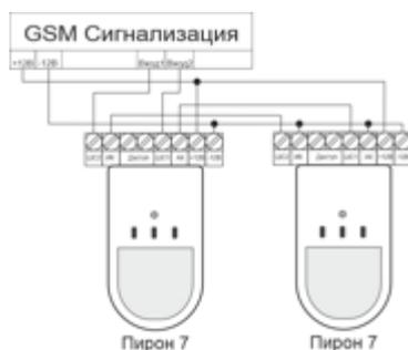
в) Подключение датчика к 1-му входу для совместного оповещения о тревоге от ИК и АК датчиков:
