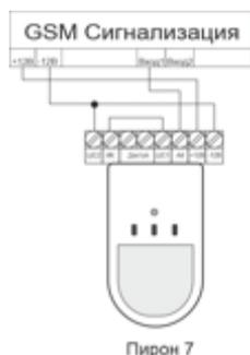
г) Подключение 2-х датчиков к 1-му входу для совместного оповещения о тревоге от ИК и АК датчиков:
