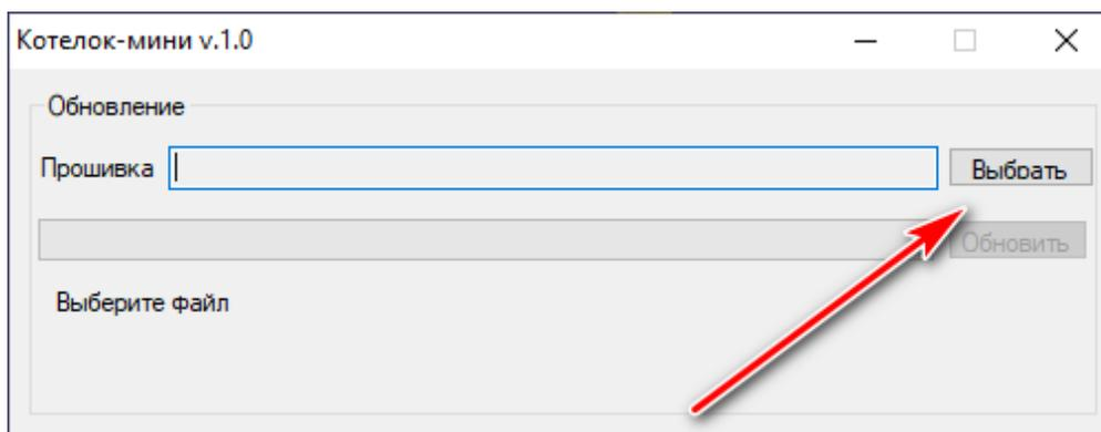
4. Появится меню выбора файла прошивки. Выбираем файл прошивки для устройства в формате «.hex» и нажимаем открыть.
