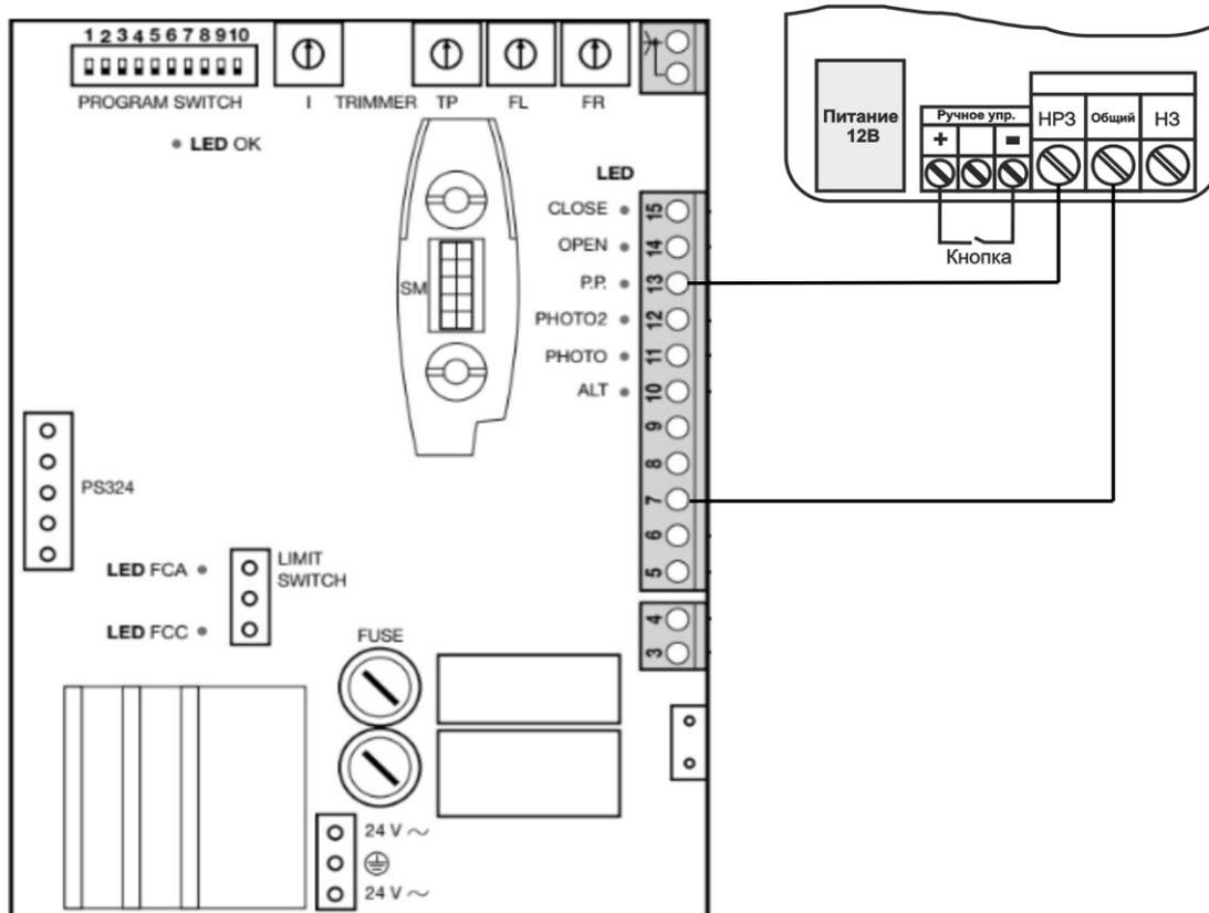
Если вы хотите осуществлять управление автоматикой вручную, кнопка ручного управления подключается к клеммам «ВХОД» и «-».
