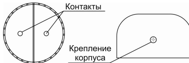
**Контрольные контакты** – при контакте обоих контактов с жидкостью датчик отправляет сигнал «ТРЕВОГА».
