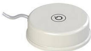
Проводной датчик протечки воды предназначен для предотвращения утечек воды в бытовых условиях. Сделан в герметичном корпусе (IP 68) с расположенным внутри электронным блоком и выносными контактами. Контакты зафиксируют даже незначительное количество жидкости на полу. Если уровень воды поднялся до 2 уровня, то будет дан сигнал на блокировку запорной арматуры.
