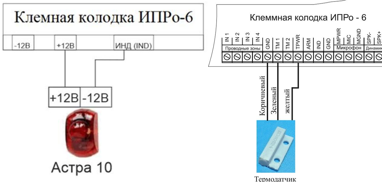
5. Подключите датчики движения и датчик дыма, как это показано ниже на схеме (резистор уже установлен):
