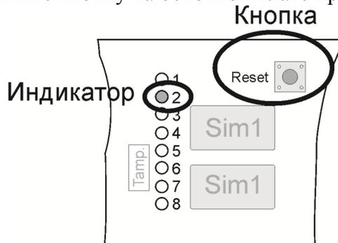
Индикатор «GSM» начнет мигать с частотой 2 раза в секунду.
