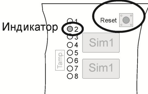
Индикатор «GSM» начнет мигать с частотой 2 раза в секунду.
