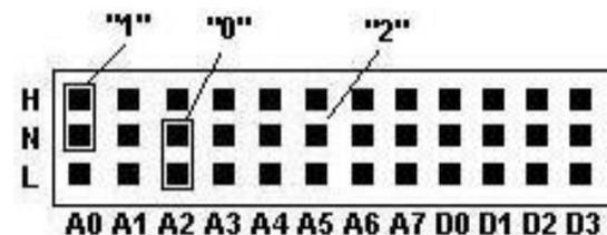
12 рядов переключателей разделены на 2 сектора **A0...A7** и **D0...D3**. Для программирования датчика необходимо выставить переключки в зоне "А" в и В зоне "D" в произвольном порядке, для обеспечения уникального кода датчика.
