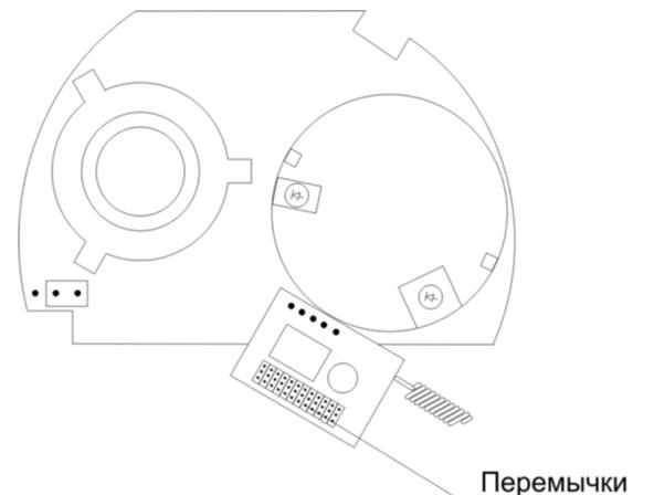
Использовать перемычки для установки адреса детектора (перемычки установлены изготовителем). Для настройки датчика к конкретной панели предусмотрена кодировка перемычками. Внутри датчика находятся 12 рядов перемычек разделенные на три полосы ("L", "N", "H").
