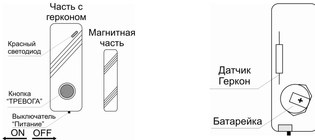
**Красный светодиод** – светится в случае передачи сигнала тревоги. При нажатии кнопки «Тревога» светится в течении 1 секунды. При низком заряде батарейки светодиод светится постоянно.
